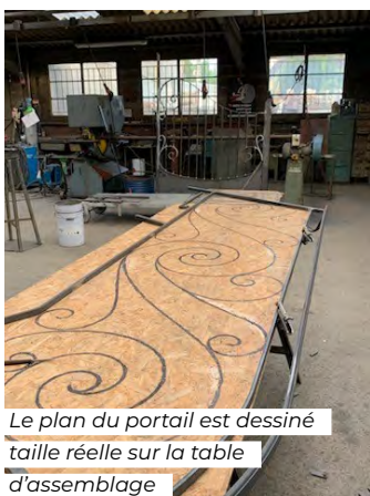
Après leur fabrication à la forge, les volutes sont assemblées selon le plan.
